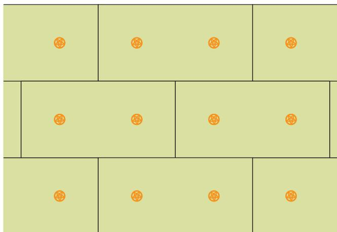
Fig. 4: Exemple de disposition du matériel de fixation
